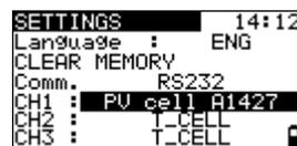
Figura 3-5: Selezione del sensore di irraggiamento
