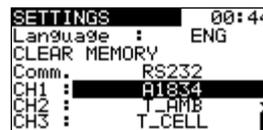
Figura 4-5: Selezione del sensore di irraggiamento
