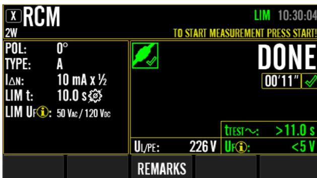
Figura53: Risultato della misurazione RCM (tipo A), esempio
