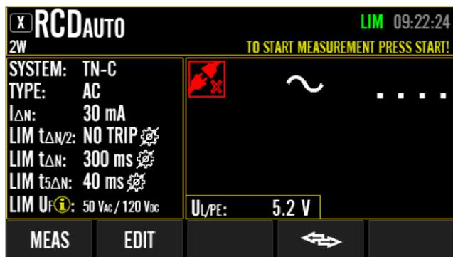
Figura 48: Schermata inattiva nella misurazione RCDAUTO, esempio
