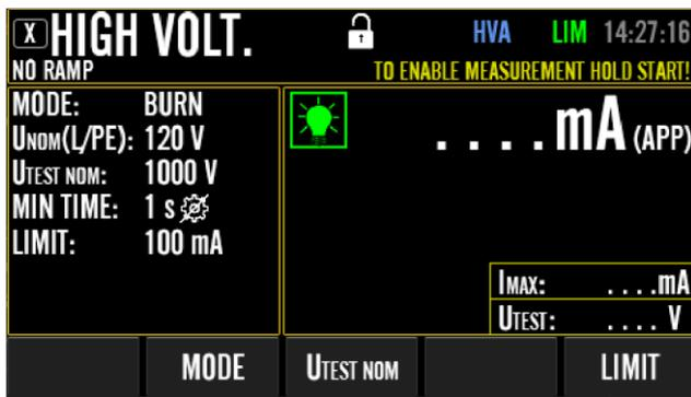
Figura 76: Schermata inattiva HV (modalità BURN) con estensione gamma di tasti del menu(dopo aver premuto il tasto menu "MODIFICA"), esempio
