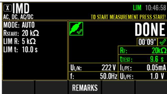
Figura60: Risultato della misurazione IMD (modalità AUTO), esempio
