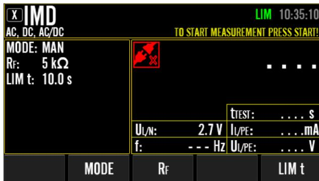
Figura 56: Schermata inattiva nella misurazione IMD (modalità MAN) con gamma estesa di tasti menu (dopo aver premuto il tasto menu "MODIFICA"), esempio
