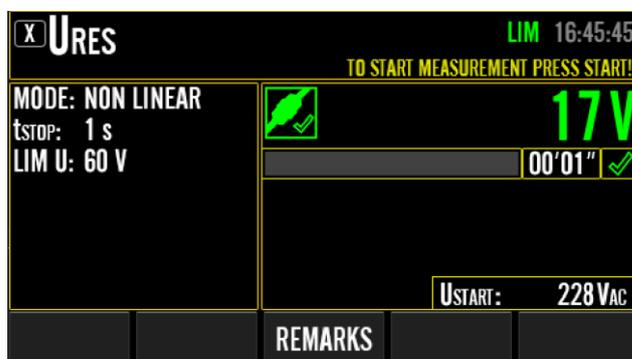
Figura92: Risultato della misurazione URES in modalità NON LINEARE, esempio
