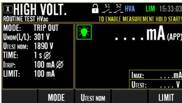
Figura 82: Misura HVAC ROUTINE TEST, modalità TRIP OUT) schermata inattiva con estensione gamma di tasti del menu(dopo aver premuto il tasto menu “MODIFICA”), esempio
