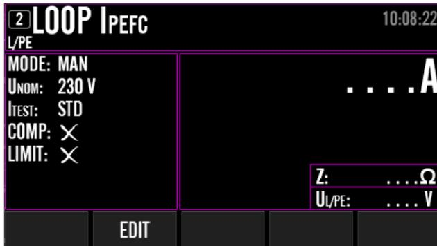
Figura148. Fase di test selezionata (LOOP) nel terzo livello di visualizzazione/modifica, ovvero nella schermata di misurazione, esempio
