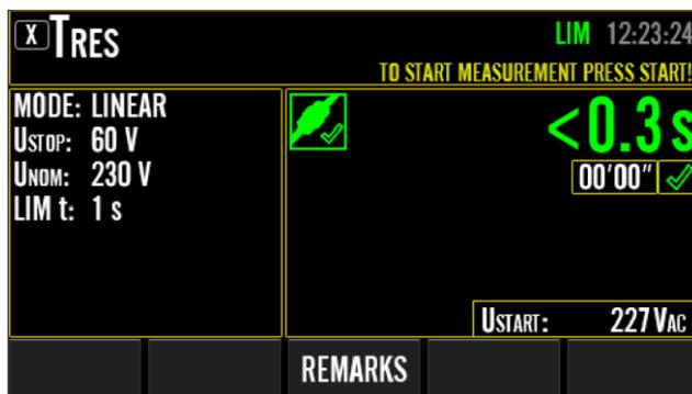
Figura96: risultato della misurazione tRES in modalità LINEARE, esempio
