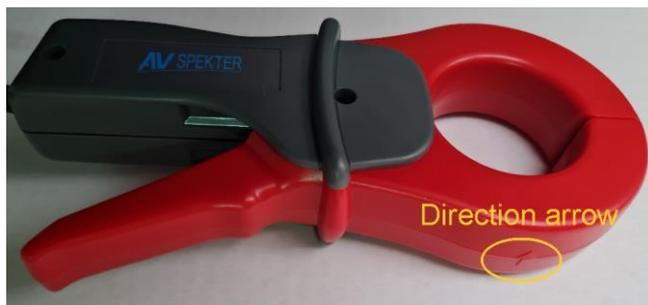
Figura 115: Direzione contrassegnata sul tipo di pinza amperometrica CC-204-1000A
