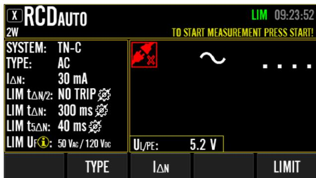
Figura 49: Schermata inattiva nella misurazione RCDAUTO con gamma estesa di tasti menu (dopo aver premuto il tasto menu "MODIFICA"), esempio
