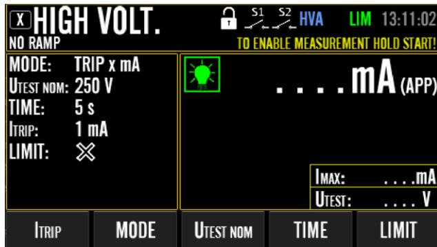
Figura 71: Schermata inattiva HV (misurazione RAMPA NO, modalità TRIP × mA) con estensione gamma di tasti del menu (dopo aver premuto il tasto menu "MODIFICA"), esempio
