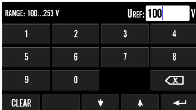
Figura 34: Schermata di regolazione UREF con tastiera numerica, esempio
