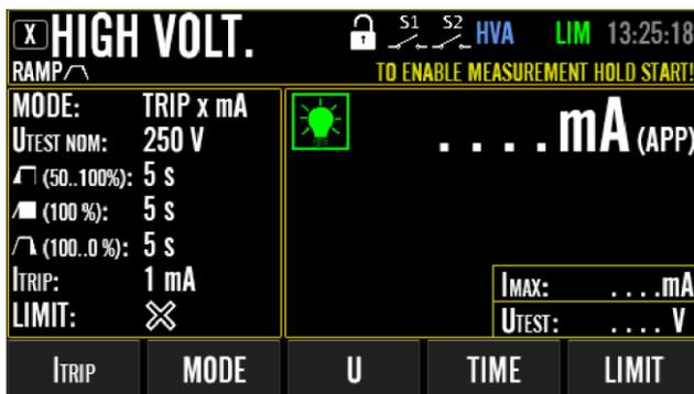
Figura 75: Alta tensione (RAMPA
