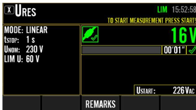
Figura89: Risultato della misurazione URES in modalità LINEARE, esempio
