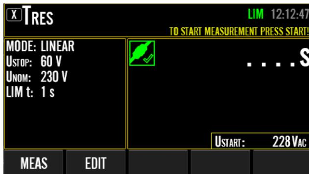
Figura95: Schermata inattiva nella misurazione TRES, esempio
