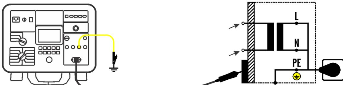
Figura 107: Toccare il collegamento per la misurazione della corrente, esempio.
