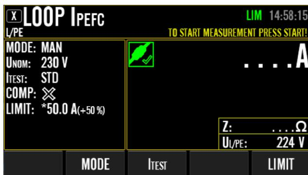
Figura19: LOOP IPEFC (L/PE) schermata inattiva con estensione gamma di tasti del menu (Dopo premendo il tasto del menu "MODIFICA"), esempio
