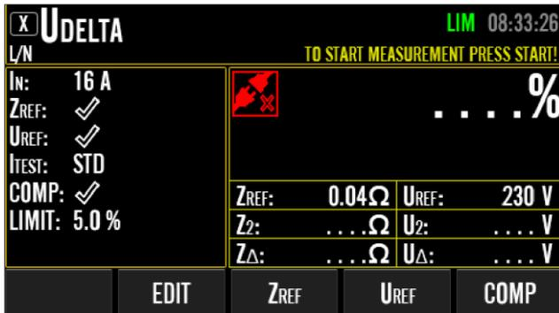
Figura 31: schermata inattiva UDELTA misurazione, esempio
