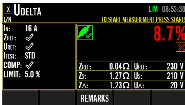
Figura 37: risultato finale nella misurazione UDELTA, esempio
