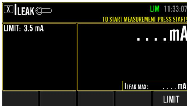
Figura103: Schermata inattiva ILEAK con estensione gamma di tasti del menu, esempio (dopo aver premuto tasto menù "MODIFICA")
