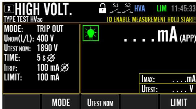
Figura 79: Schermata inattiva HV (misurazione TYPE TEST HVAC, modalità TRIP OUT) con estensione gamma di tasti del menu (dopo aver premuto il tasto menu "MODIFICA"), esempio
