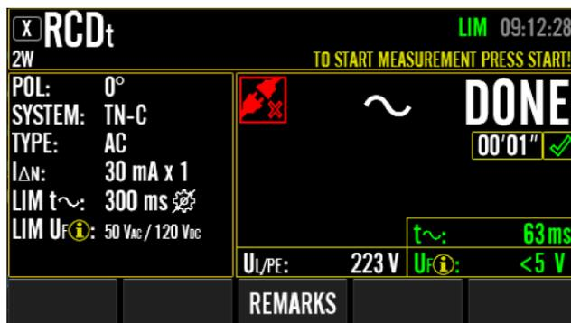
Figura 45: Risultato della misurazione RCDt, esempio
