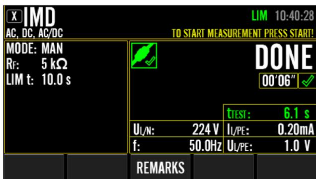
Figura 58: Risultato della misurazione IMD (modalità MAN), esempio
