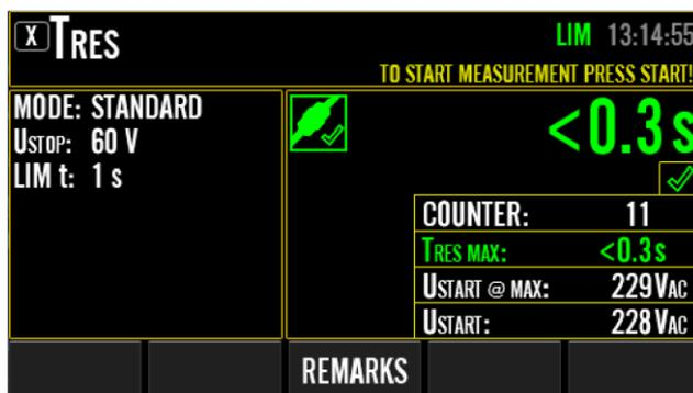
Figura99: risultato della misurazione tRES in modalità STANDARD, esempio
