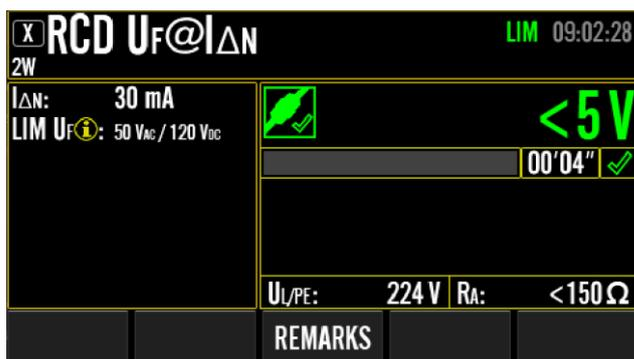
Figura42: RCD UF@I $\Delta$ Risultato della misurazione N, esempio
