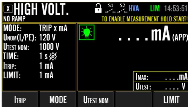
Figura 78: Schermata HV (modalità TRIP × mA) inattiva con estensione gamma di tasti del menu (dopo aver premuto il tasto menu “MODIFICA”), esempio
